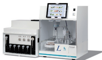
全自動固相抽出装置 ST-L400（株式会社アイスティサイエンス社製）
