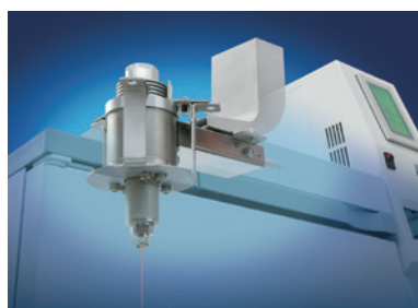
GC 大量注入装置 LVI-S250 (株式会社アイスティサイエンス社製)
