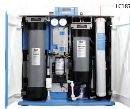
CENTRA-R 60 の純水カートリッジ装着例 純水カートリッジ (型番 LC187) 5 MΩ・cm の純水が約 44,000 ℓ 採水可能
